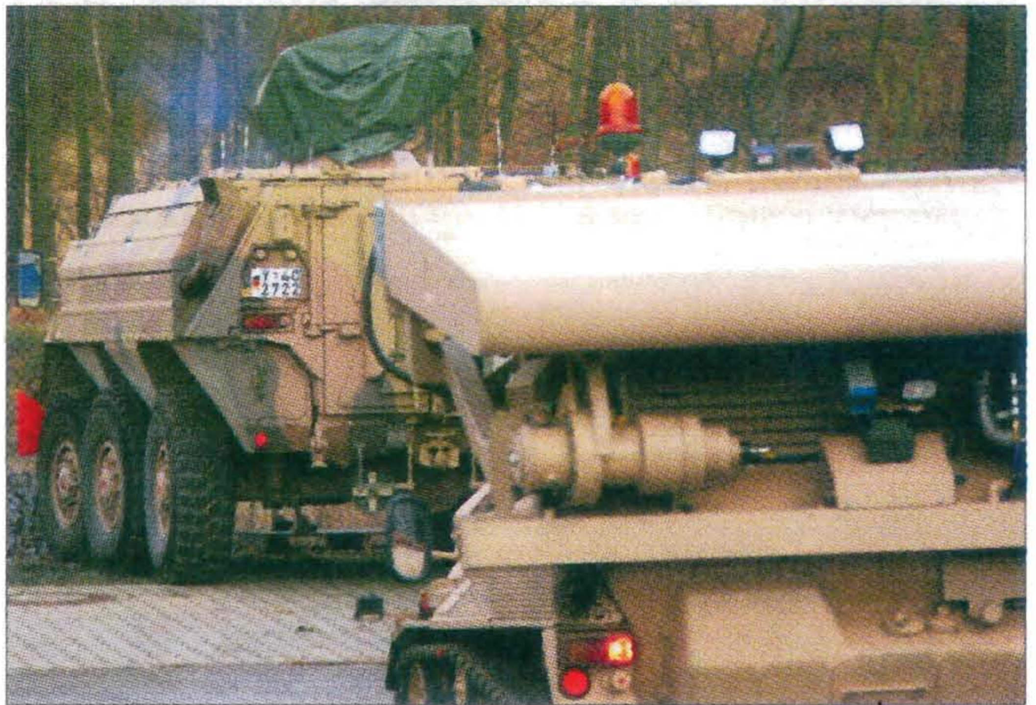
Машины управления ССВ (на заднем плане) и обнаружения взрывных устройств RCDV на базе БМ «Визель-1»
