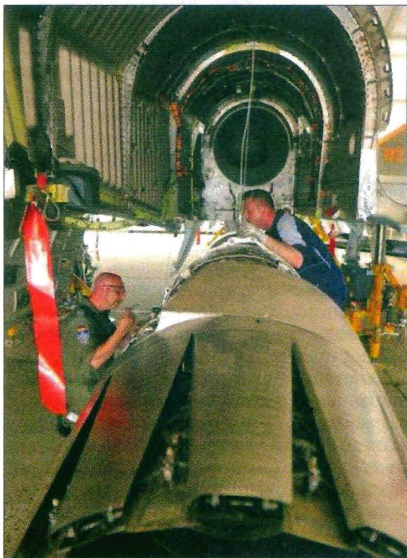
Сборка турбовентиляторного двигателя EJ200, используемого в производстве многоцелевого истребителя «Еврофайтер Тайфун»
