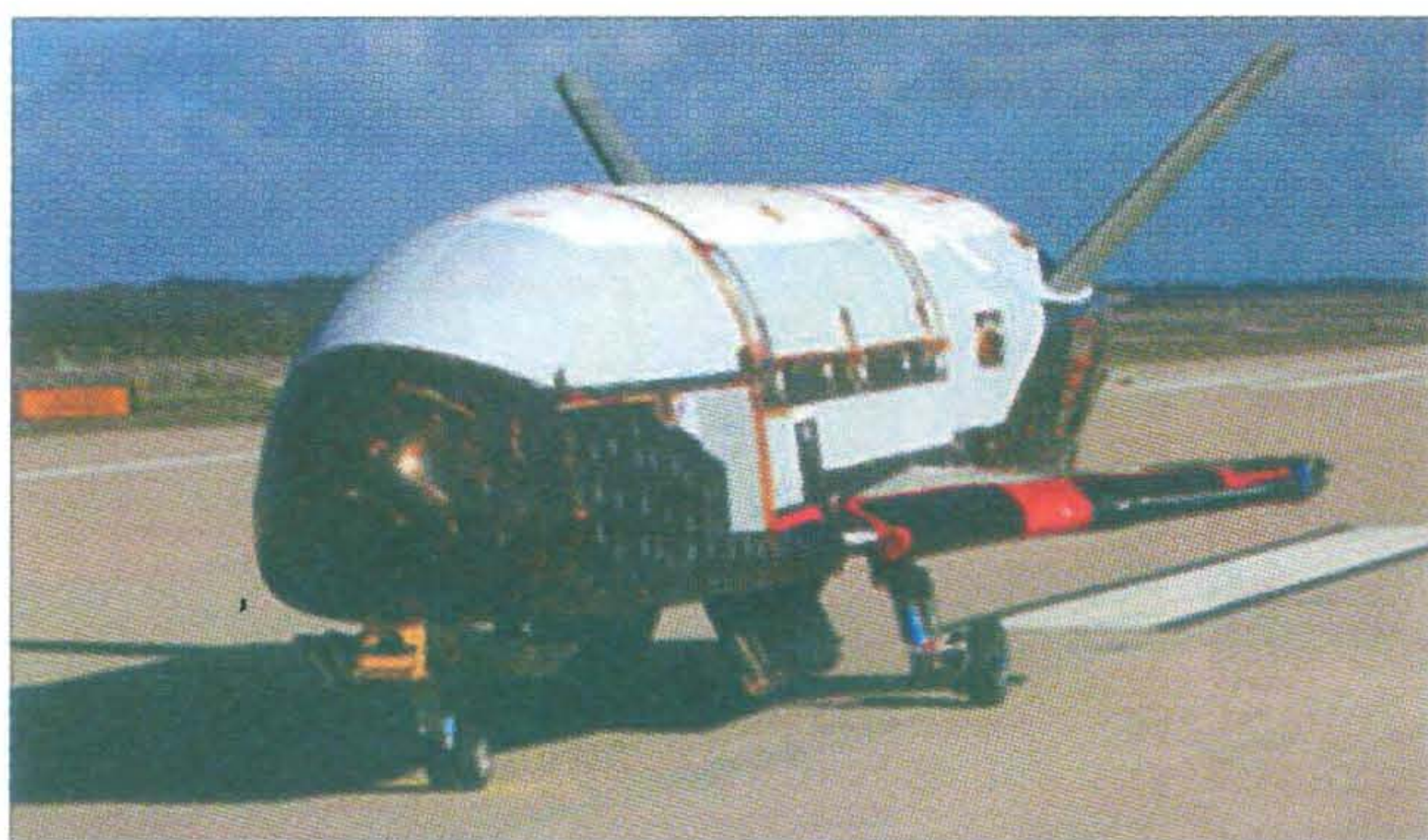
Экспериментальный многоразовый космический аппарат военного назначения X-37B в ходе предстартовой оценки посадочных устройств на Восточном ракетном полигоне
