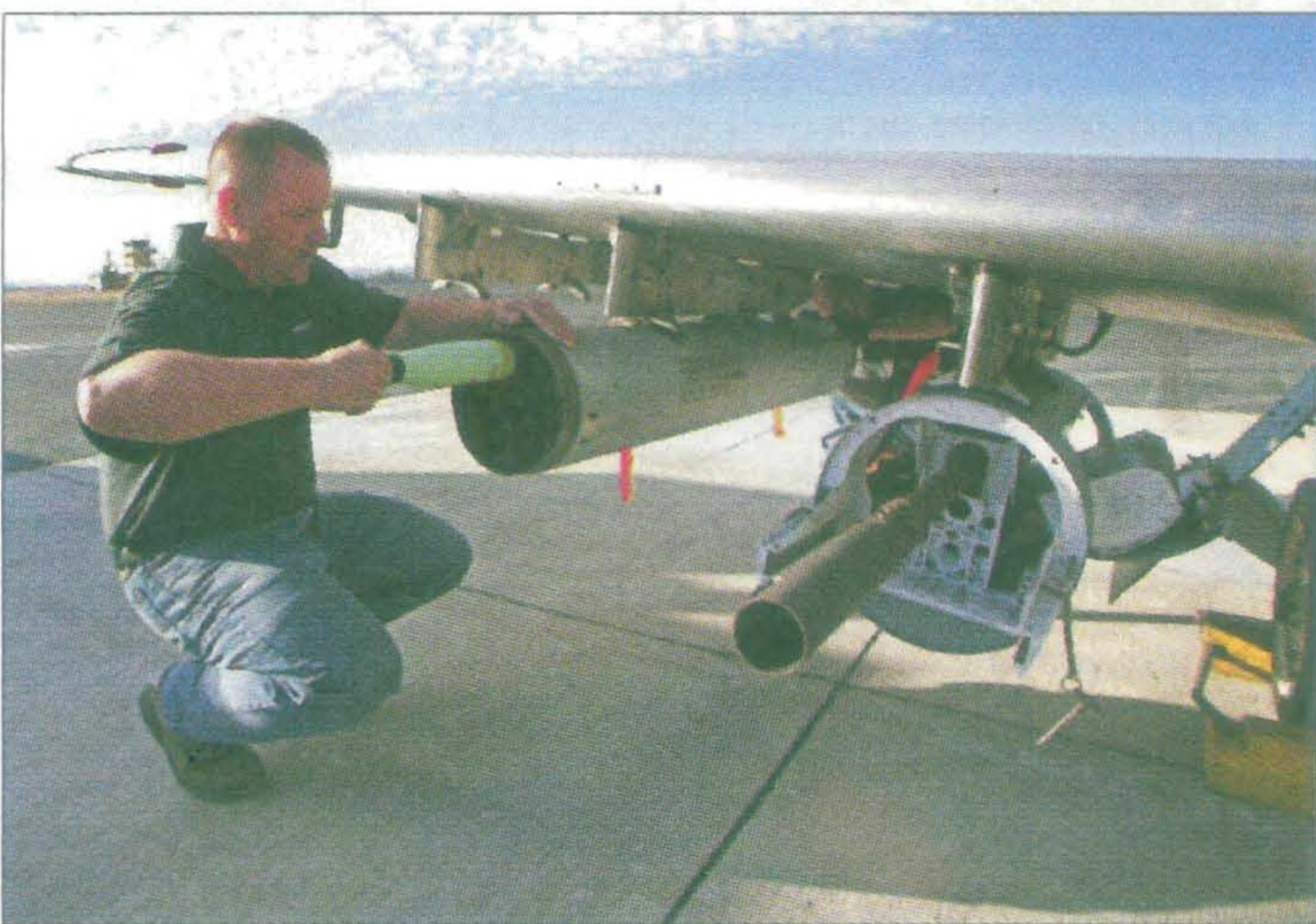
На шести подкрыльевых пилонах легкого штурмовика AT-6B может быть размещена широкая номенклатура вооружения класса «воздух – земля»
