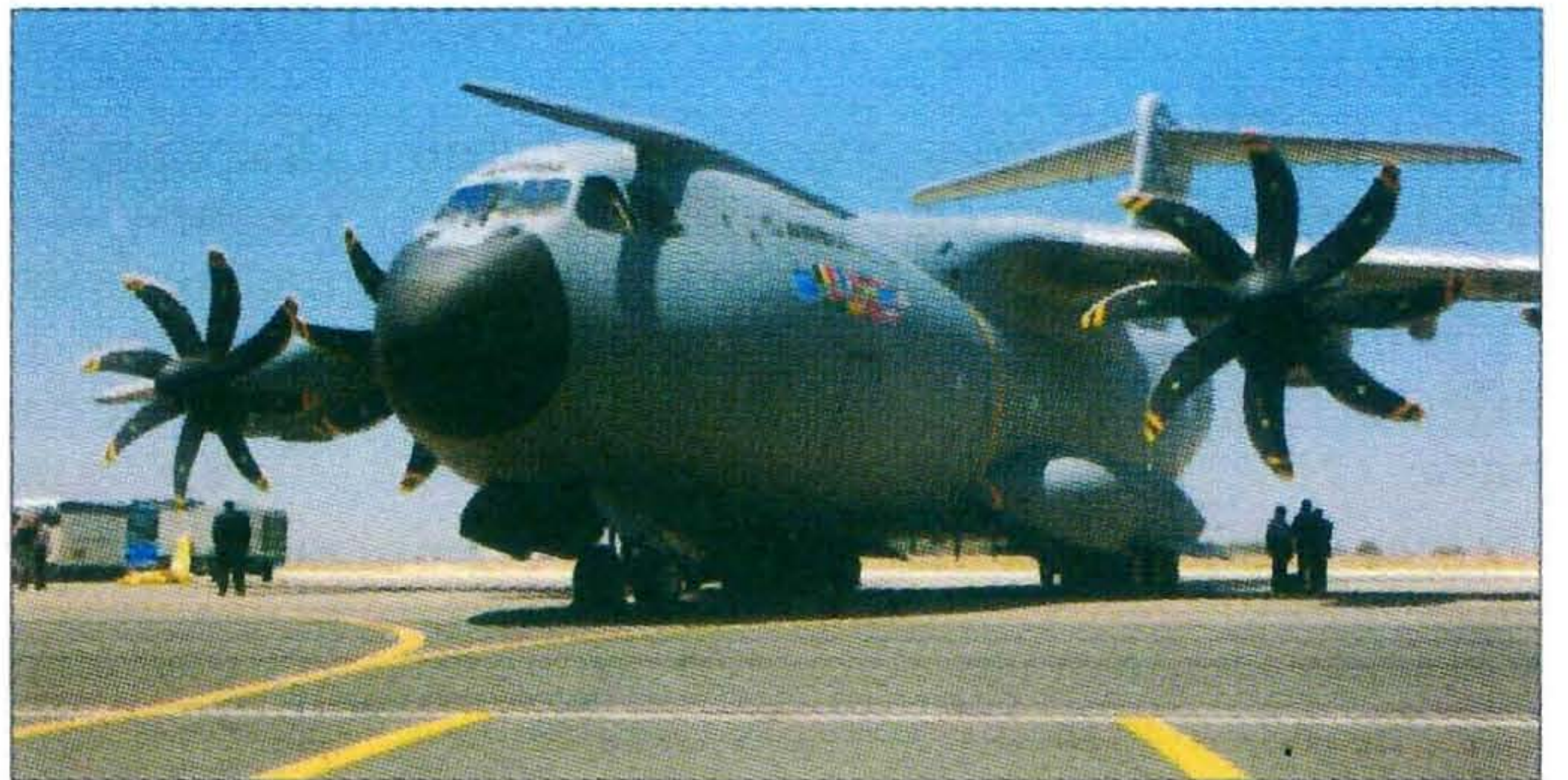
Четырехмоторный турбовинтовой широкофюзеляжный военно-транспортный самолет А.400М, разрабатываемый компанией «Эрбас милитэри»
