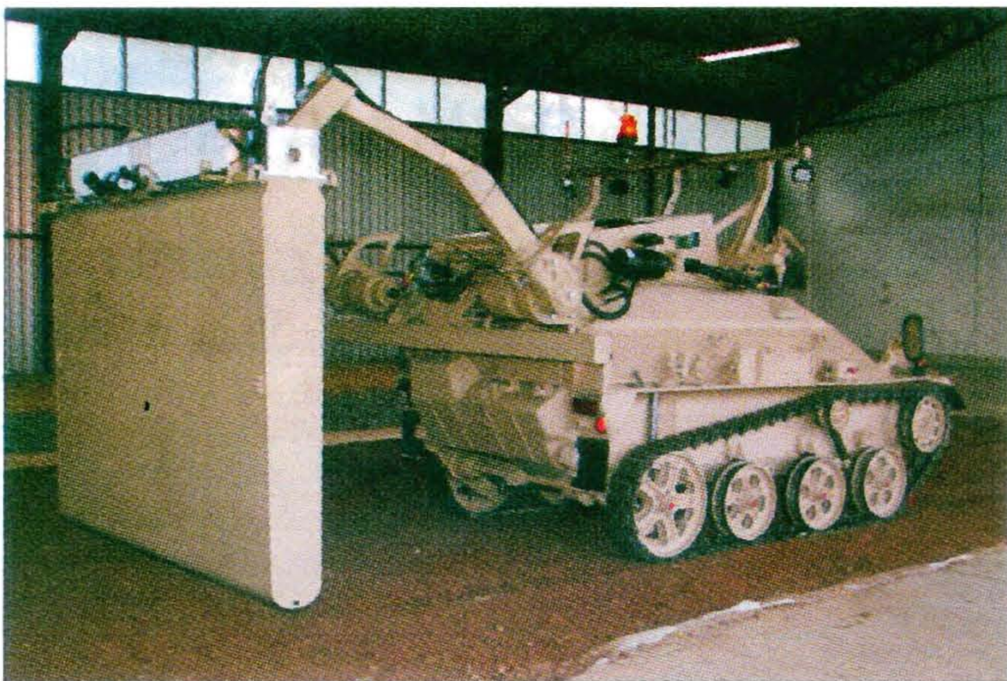
Дистанционно управляемая машина обнаружения взрывных устройств RCDV на базе БМ «Визель-1»
